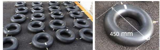
図3 水を充填したゴム製弾性トラス(1個約12kg) (2)
