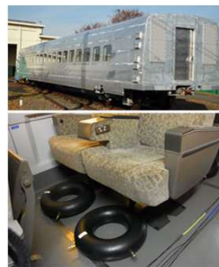
(a) 供試車両と車内の弾性トラス積載状況
