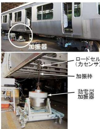
図4 車体の定置加振試験<sup>(1)</sup>
