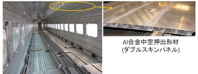
(a) アルミニウム合金(Al合金)製構体の例
